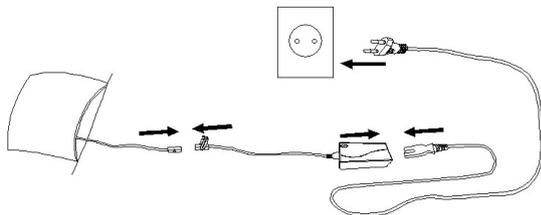
Vergewissern Sie sich, dass die auf dem Typenschild angegebenen elektrischen Anschlussdaten mit den Parametern des Versorgungsnetzes übereinstimmen. Wenn nicht, wenden Sie sich an einen Elektriker.
